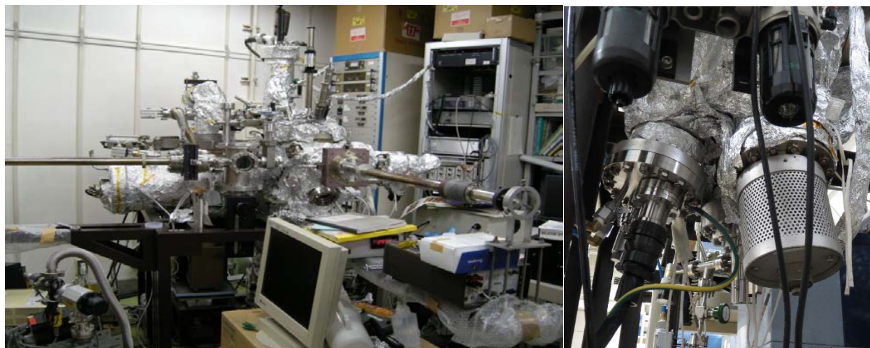
図9 (左図)Ge ソース分子線エピタキシー装置概観。(右図)B 原子蒸着用の EB ガン(左)と Ge 原子蒸着用のセル(右)。
